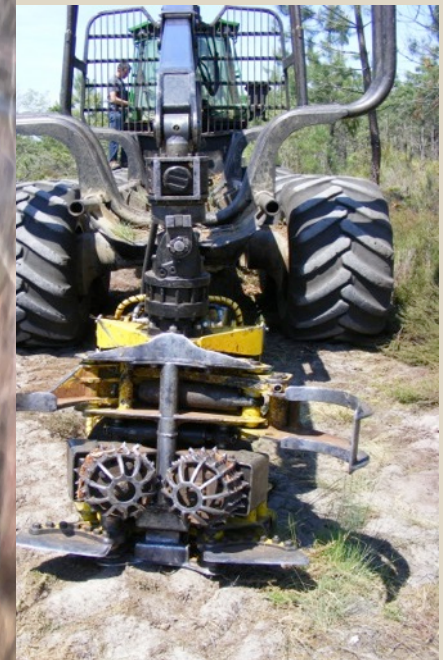
Figure 4 & 5 : Porteur équipé d'une tête d'abattage Moipu. (Source : Auteur, 2013).
