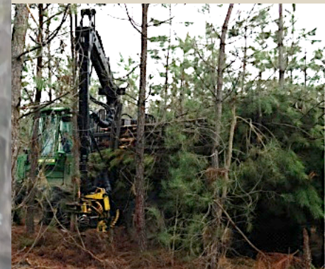
Figure 4 & 5 : Porteur équipé d'une tête d'abattage Moipu. (Source : Auteur, 2013).
