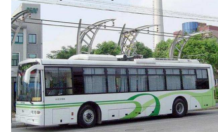
Bus électrique à supercondensateur
