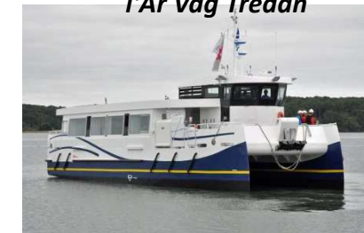
Bateau électrique à supercondensateur : l'Ar Vag Tredan
