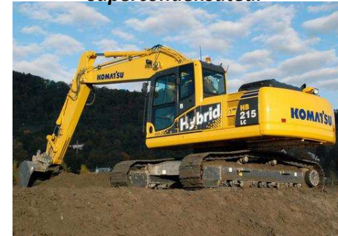
Pelle hybride Komatsu avec supercondensateur
