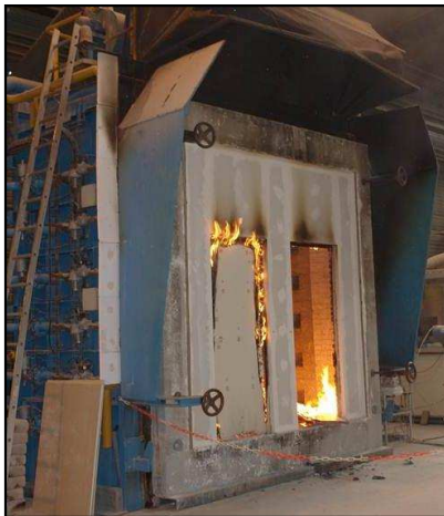
Four d'essai vertical - EFACTIS France
