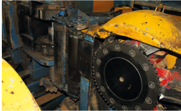
Tête de canter MEM (sous le canter jaune) et fraises de profilage dans le prolongement.
