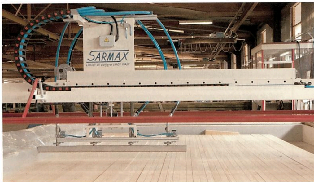
Depuis octobre 2014, Sacba est équipée d'une presse à membrane Sarmax pour fabriquer les panneaux de structure Bosco CLT Sacba.
