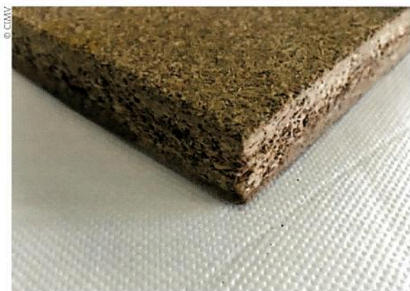
CE PANNEAU DE PARTICULES UTILISE UNE COLLE À BASE DE LIGNINE.
