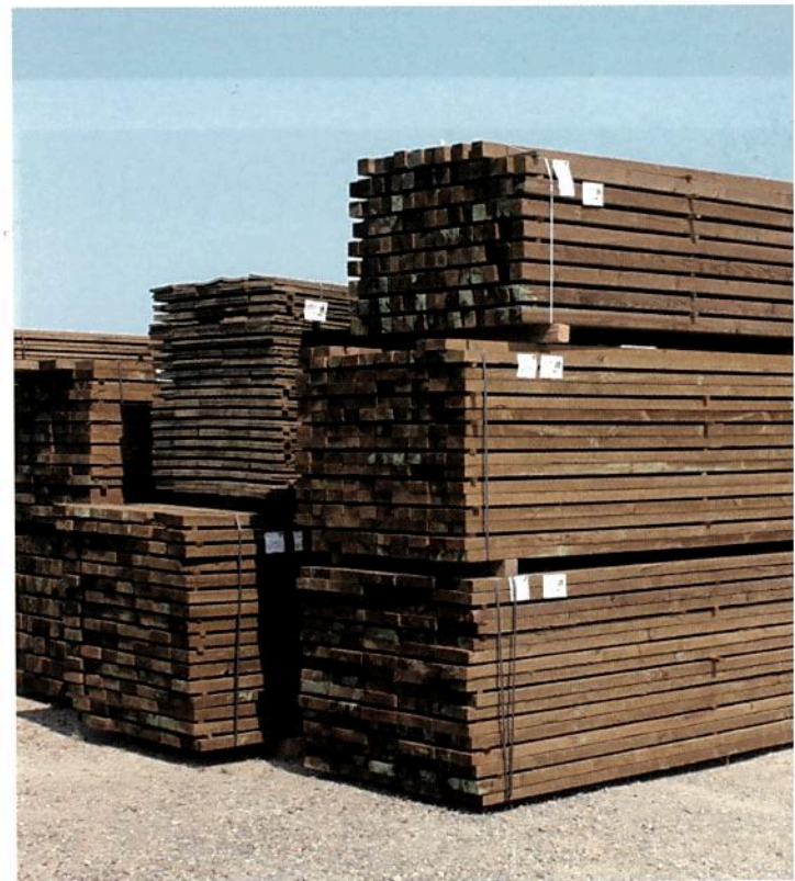
▲ ▼ Le nouvel autoclave permet de traiter 10 000 mètres cubes de bois par an en classe 3 ou 4, de couleur verte ou marron, pour une parfaite imprégnation du pin maritime destiné à la construction.
