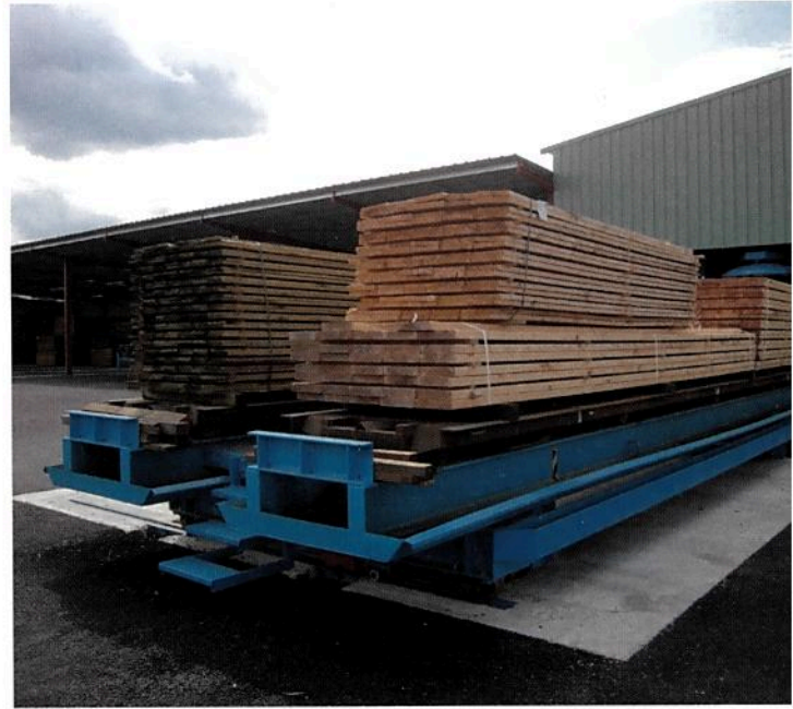
▲ ▼ Le nouvel autoclave permet de traiter 10 000 mètres cubes de bois par an en classe 3 ou 4, de couleur verte ou marron, pour une parfaite imprégnation du pin maritime destiné à la construction.
