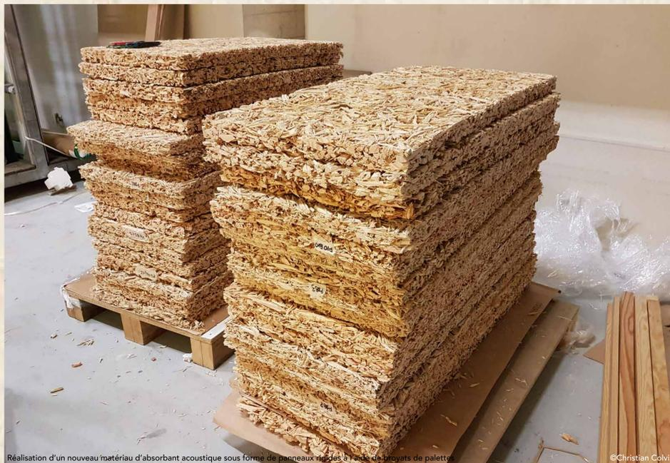
Réalisation d'un nouveau matériau d'absorbant acoustique sous forme de panneaux rigides à l'aide de broyats de palettes ©Christian Colvis
