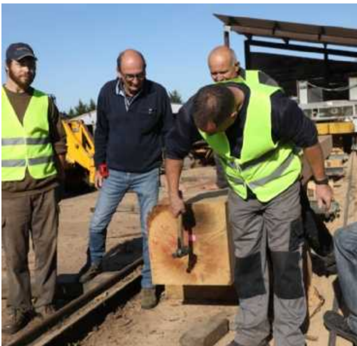
Après avoir été sciée, la poutre est marquée pour le traçage.
