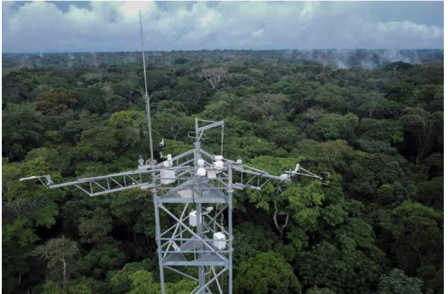
Cette « tour à flux » de 55 mètres de haut qui permet de quantifier le carbone absorbé ou émis par la forêt, se dresse dans le décor luxuriant de la réserve de biosphère de Yangambi. GUERCHOM NDEBO/AFP
